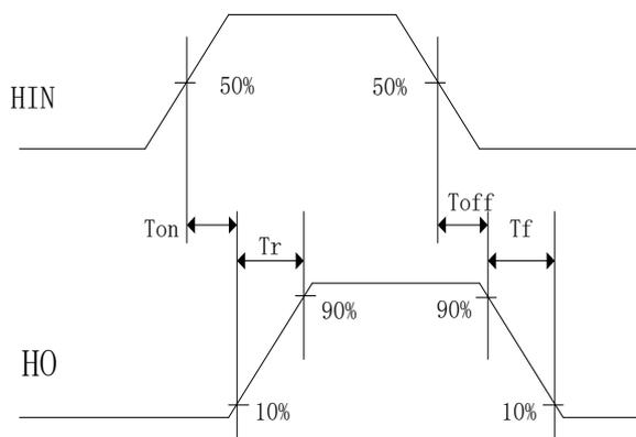
图 7-2. 高端输出 HO 开关时间波形图
