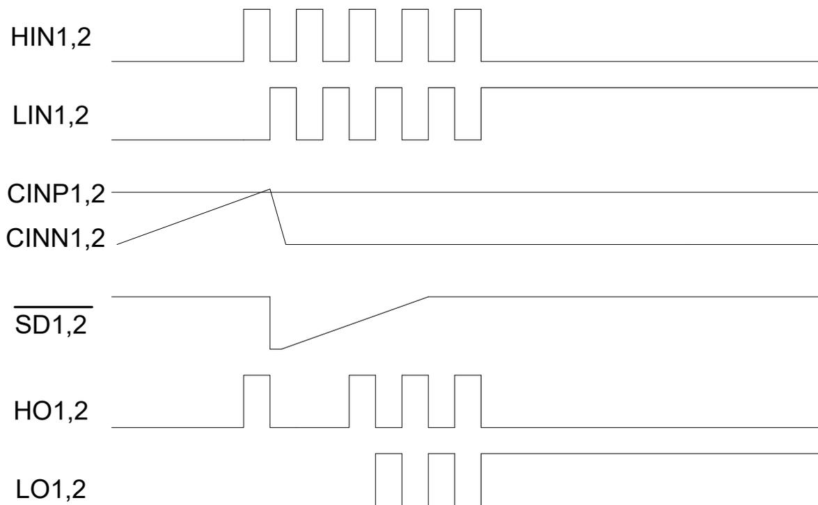
图8-1. 输入信号和输出信号逻辑功能图
